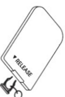
Entnehmen Sie die leere Batterie und ersetzen diese durch eine neue. Legen Sie diese mit dem Pluszeichen nach oben in die Halterung.
