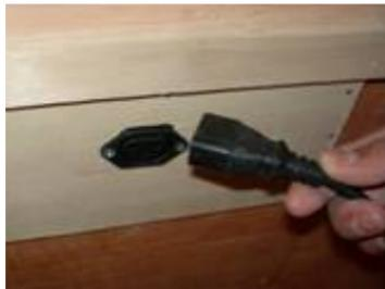
4. Das Deckenelement muß so positioniert werden, das sich die Kabel in der vorderen linken Ecke befinden, direkt überm Radio. Führen Sie die Kabel der Heizung durch die entsprechenden Bohrungen im
