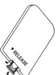
Entnehmen Sie die Halterung der Batterie, indem Sie den Stopper gedrückt halten und die Halterung herausziehen.
